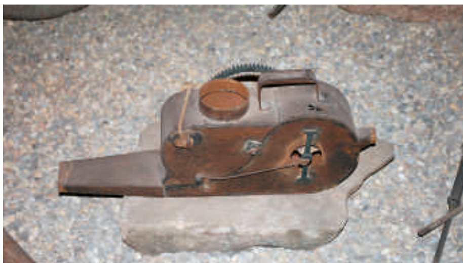
Souffleuse mécanique de soufre vers 1930
